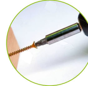
7 Cargols 5x80 mm per cargolar el rastrell de 40 mm a la paret
